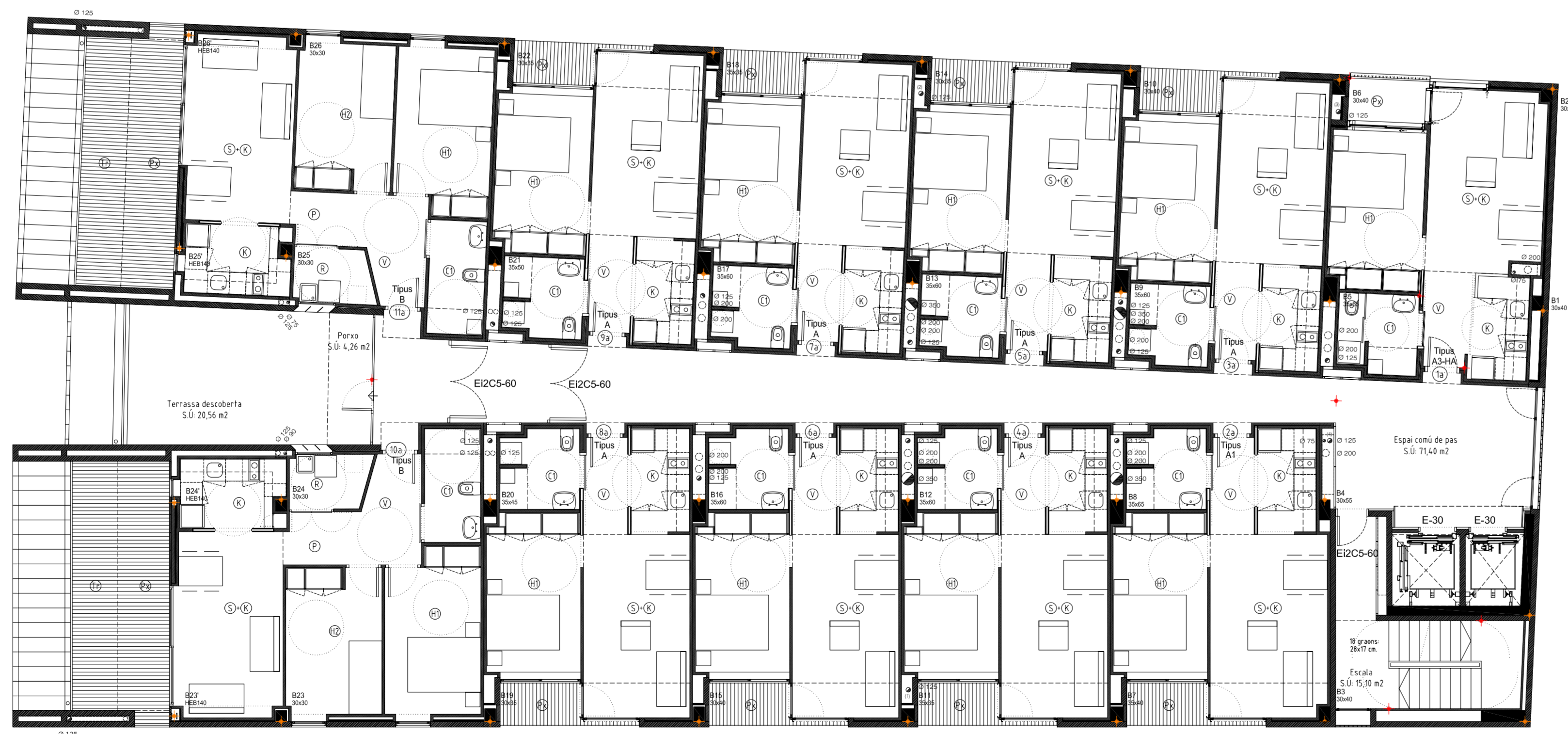
PLANTA PRIMERA (BLOC A) +16,33 TOTAL SUPERFÍCIE CONSTRUÏDA 758,17 M 2 SUPERFÍCIE SOSTRE OCUPAT 753,04 M 2
